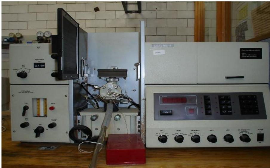
**Figura 2.3** Espectrofotómetro de Absorción Atómica, PERKIN- ELMER 2380
