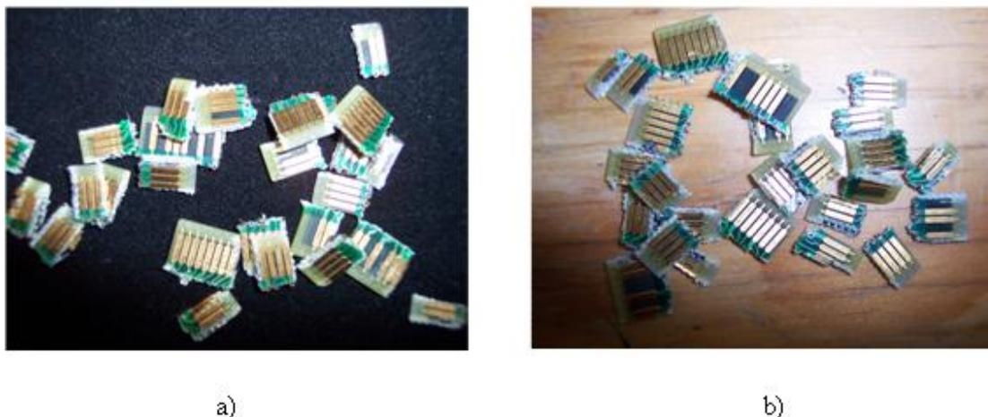
**Figura 3.4.** Imagen de los recortes de las placas de circuitos impresos: a) Antes del tratamiento, b) Después del tratamiento.
